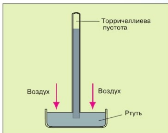
Рис. 95. Барометр Торричелли и принцип его действия
